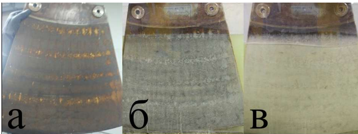
Рисунок 32 – Визуальная оценка очистки керамического фильтрующего элемента при регенерации предложенной композицией: а – до регенерации, б – после 4 часов регенерации, в – после 12 часов регенерации
