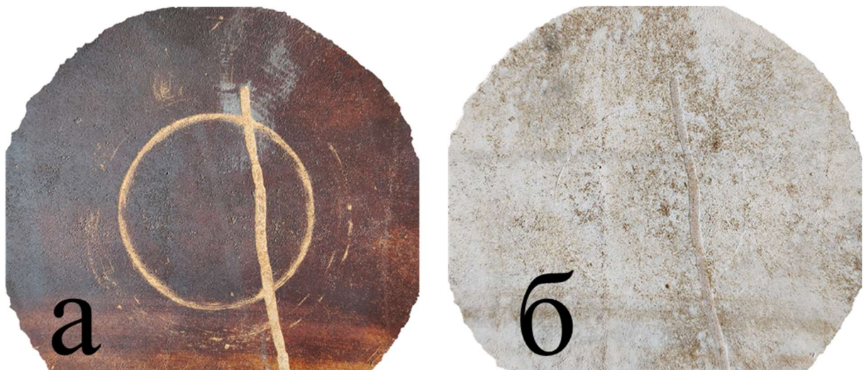
Рисунок 31 – Керн фильтрующего элемента до (а) и после (б) обработки предлагаемым регенерационным составом
