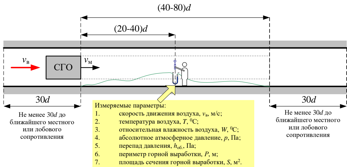
Рисунок 2.7 – Схема проведения измерений при попутном движении СГО и воздуха
