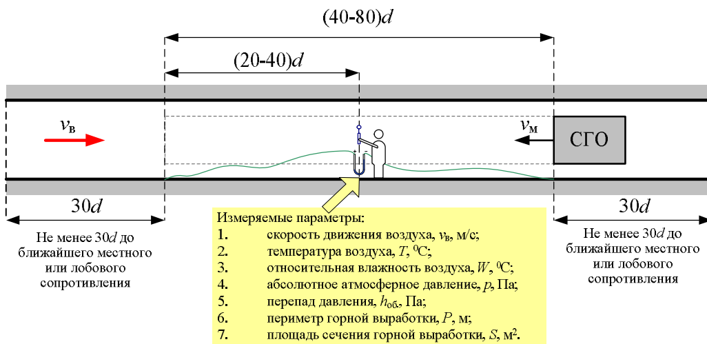
Рисунок 2.6 – Схема проведения измерений при встречном движении СГО и воздуха
