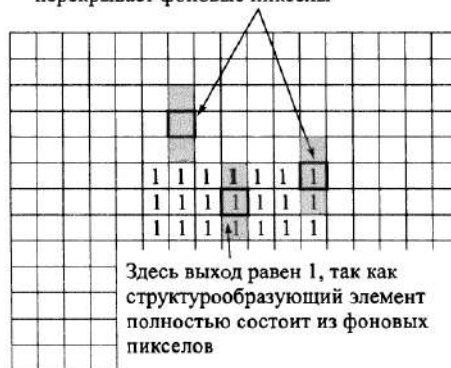
Рисунок 1.4.7 – Принципиальная схема эрозии цифрового изображения.
