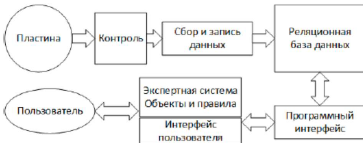
Рисунок 1.6.1 – Общая структура обработки данных в информационной системе полупроводникового производства [159]
