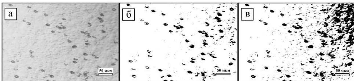
а – исходное выражение; б – бинаризация с порогом 160; Бинаризация с порогом 180; Рисунок 1.4.4 – Цифровое изображений дислокационных ямок травления в монокристаллическом GaAs (100)
