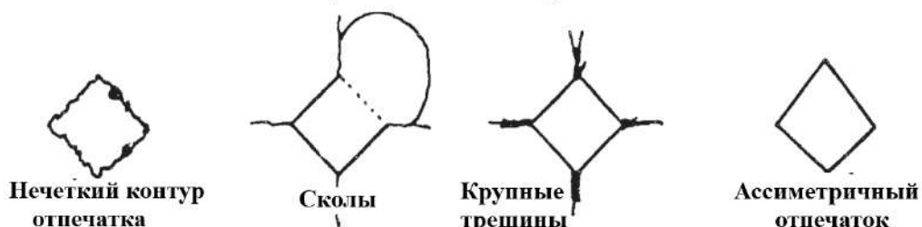
Рисунок 4.3 – Схема выбора отпечатка для объективной оценки микротвердости керамик
