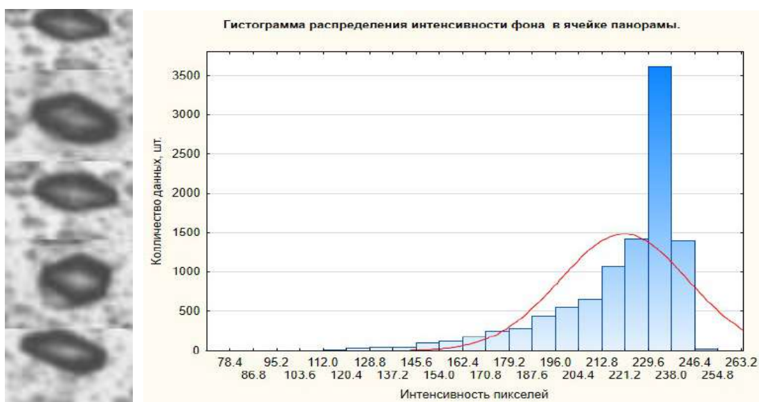
Рисунок 1.4.5 – Дислокационные ямки травления на поверхности пластины GaAs(100) и гистограмма распределения уровня серого
