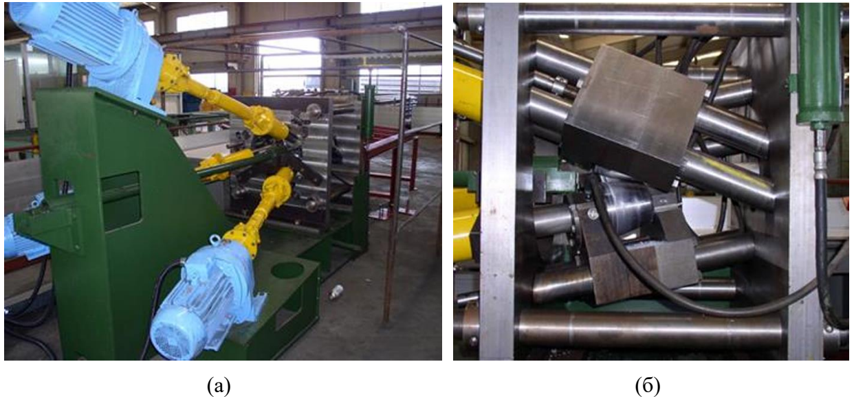
Рисунок 1.16 – (а) министан РСП 20-45; (б) рабочая клеть с компоновкой валковых узлов
