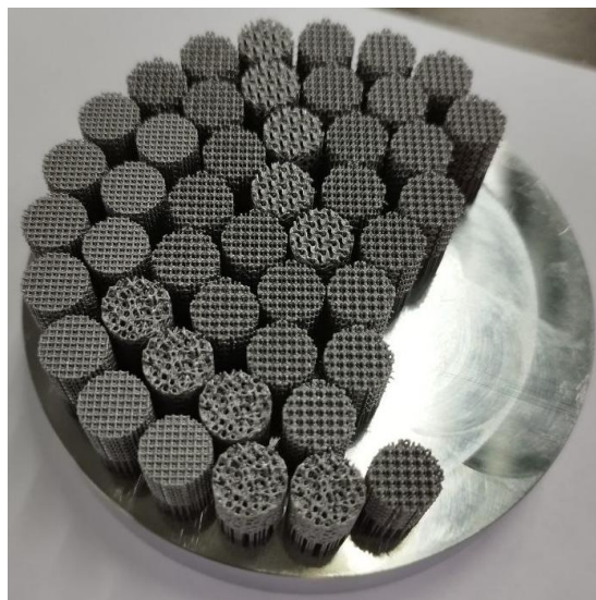
Рисунок 4.14 – Образцы TZN-Д-2-300; TZN-Д-2-350; TZN-Д-2-400; TZN-Д-1,5-250; TZN-В; TZN-Г для механических испытаний на платформе после СЛП
