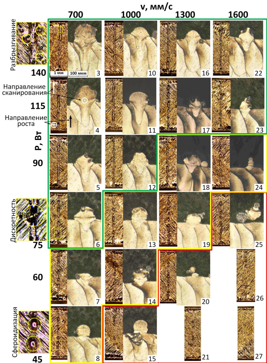
Рисунок 4.3 – Изображения следа от единичного прохода лазера и ванн расплава, сформированных единичным проходом лазера в зависимости от режима СЛП [154]
