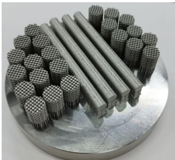
Рисунок 3.13 – Образцы из сплава Ti-Zr-Nb после СЛП на платформе
