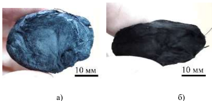
Рисунок 47 – Общий вид образцов после термической обработки в установке ЭУ-Т: а) – после прохождения этапа карбонизации в среде Ar; б) – после прохождения карбонизации в среде Ar и активации в CO 2
