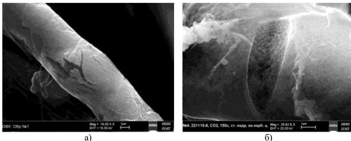
Рисунок 54 – Волокно, пропитанное раствором \text{H}_3\text{PO}_4 : а) – вздутие; б) – трещина, образовавшиеся под воздействием электронного зонда СЭМ
