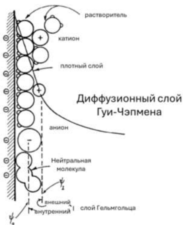
Рисунок 1 – Схема строения двойного электрического слоя на поверхности положительно заряженного электрода в водном электролите [29]
