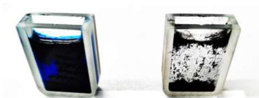
Рисунок 33 – Пробные образцы ХПс-2 после СВЧ обработки в установке ЭУ2: а) – образец (20823-3) после этапа карбонизации (без доступа кислорода); б) – образец (20823-4) после этапа карбонизации и активации на воздухе с областями «глубоко чёрного» цвета
