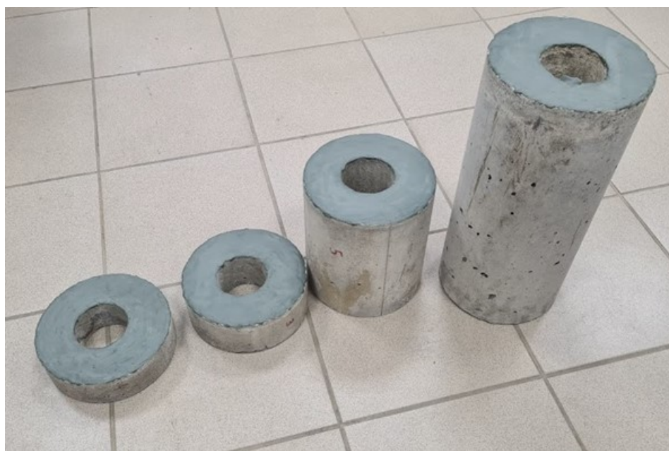
Рисунок 5.9 – Блоки с нанесённой на их торцы глиной
