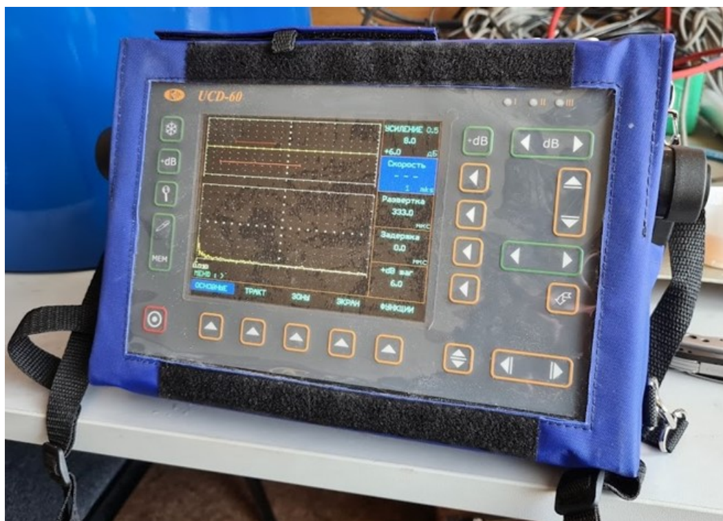
Рисунок 5.3 – Ультразвуковой низкочастотный дефектоскоп УСД-60Н
