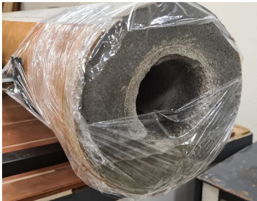
Рисунок 5.8 – Физическая модель скважины, заполненная водой
