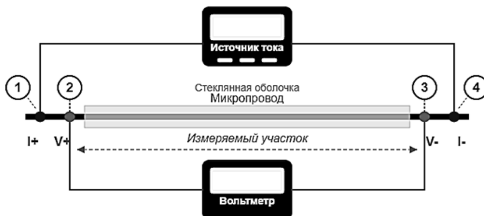
Рисунок 2.2 – Четырехзондовая схема измерения электросопротивления АФМ
