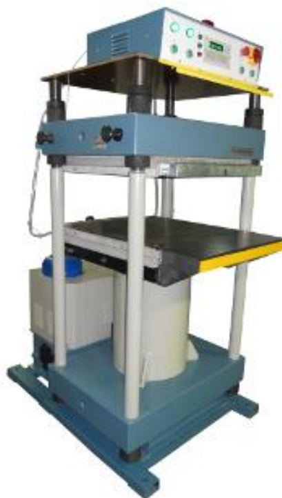
Рисунок 12 – Вулканизационный пресс гидравлический АПВМ-904
