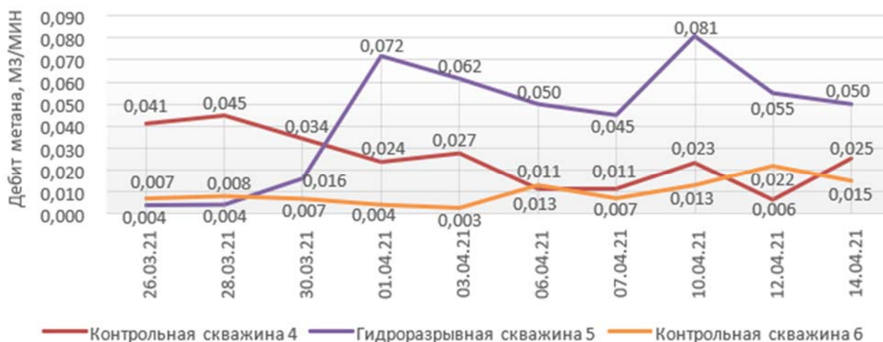
Рисунок 6 — График изменения дебита метана на скважине гидроразрыва № 5
