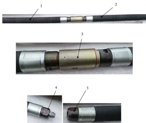
Рисунок 1 — Разрывное устройство: 1, 2 — упруго расширяющиеся рукава; 3 — межпакерный клапан; 4 — наконечник запорный; 5 — муфта присоединительная
