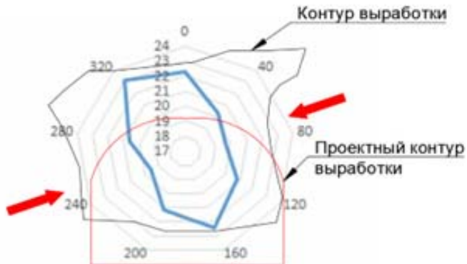
Рисунок 12 — Амплитудная диаграмма направленности ЕЭМИ в 15 м от забоя автоуклона (разрез 3-3, красные стрелки показывают направление повышенных сжимающих напряжений)
