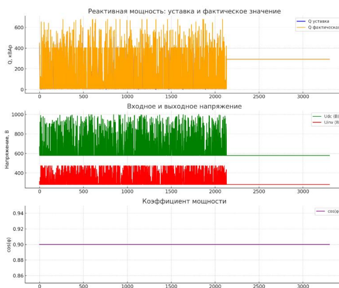
Рисунок 11 – Графики параметров инвертора с интегрированной компьютерной моделью адаптивного алгоритма регулирования реактивной мощности
