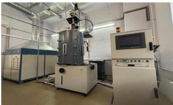
Рисунок 1 – Внешний вид нового оборудования по выращиванию монокристаллов антимонида индия увеличенного диаметра
