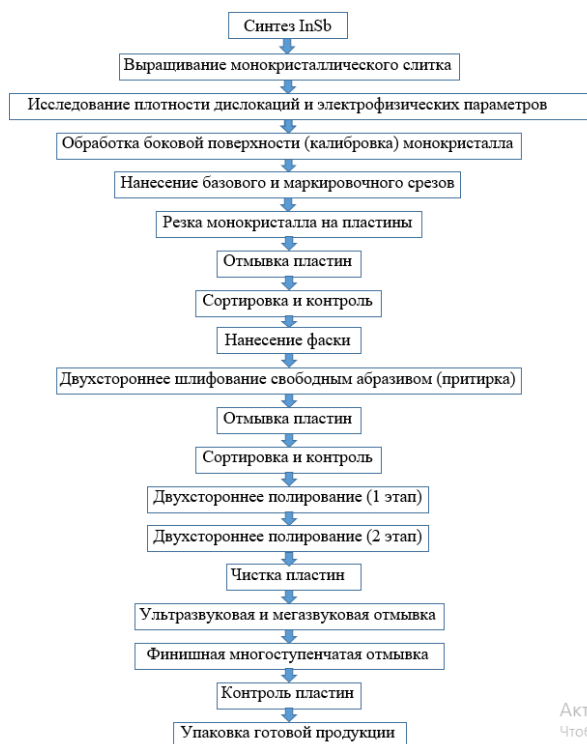
Рисунок 9 – Комплексная опытно-промышленная технология изготовления двухсторонне полированных пластин InSb
