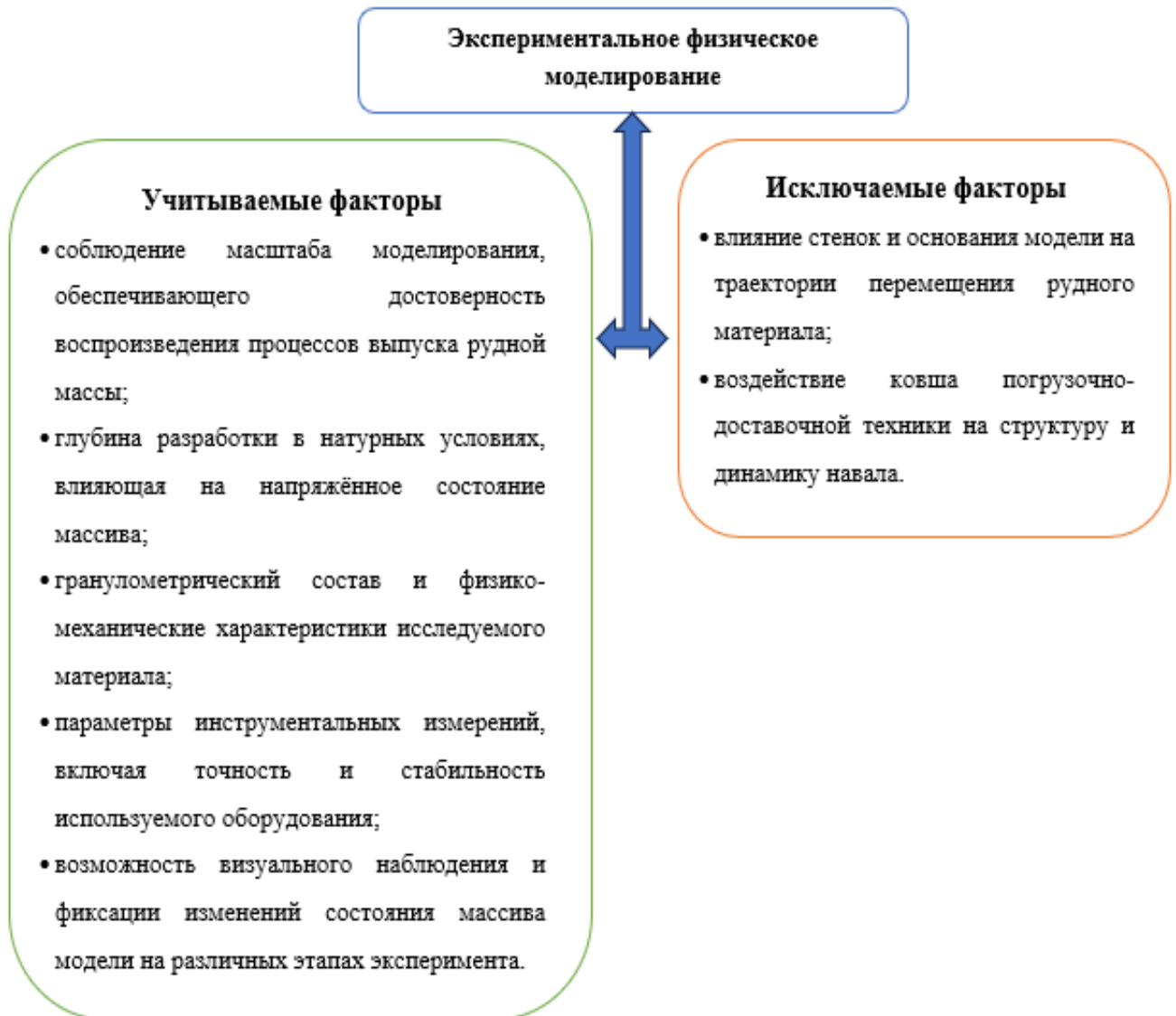
Рисунок 2.11 Учитываемые и исключаемые факторы при проведении физического моделирования
