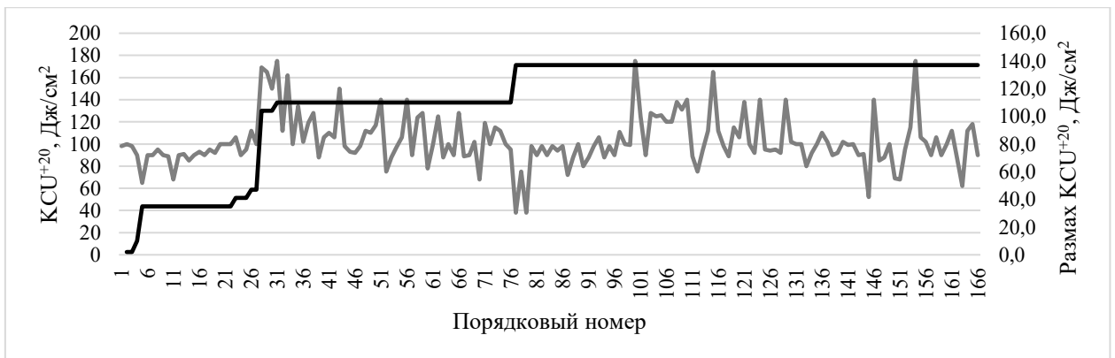
Рисунок 16 - Закономерности изменения размахов значений параметров процесса насыщения значения ударной вязкости КСУ +20 , стали 40ХМФА
