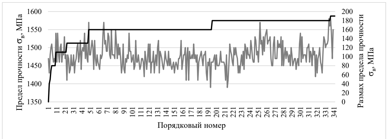
Рисунок 15 - Закономерности изменения размахов значений параметров процесса насыщения первого испытания предела прочности \sigma_B , МПа, поковок из стали 38ХНЗМФА-Ш для торцевого темплета диаметром D_s
