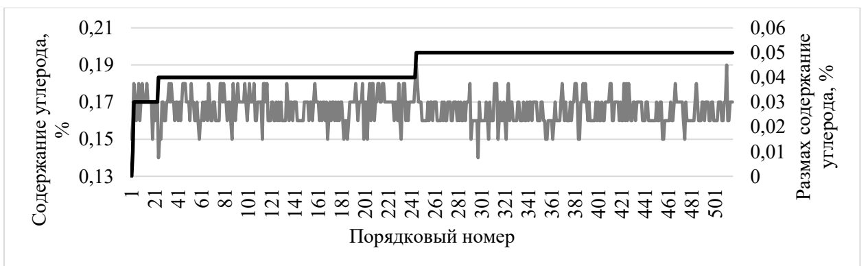
Рисунок 13 - Закономерности изменения размахов значений параметров процесса насыщения значений содержание углерода сталь 15СХНД
