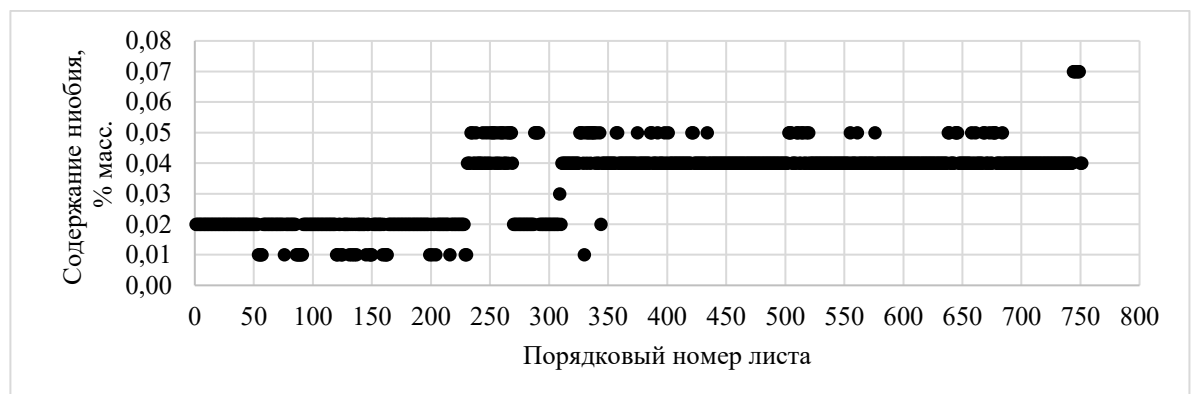
Рисунок 10 - Хронологические ряды распределения ударной вязкости KCU_{-40} (а), ударная вязкости KCV^0 (б) и сопутствующего содержания ниобия (в) в листе (толщиной 8мм) из стали 13Г1С-У [128]
