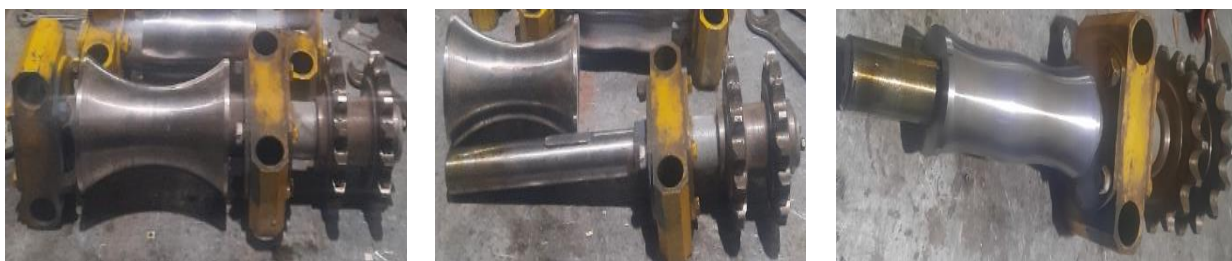
Рисунок 5.7 – Процедура замены нижнего валкового узла
