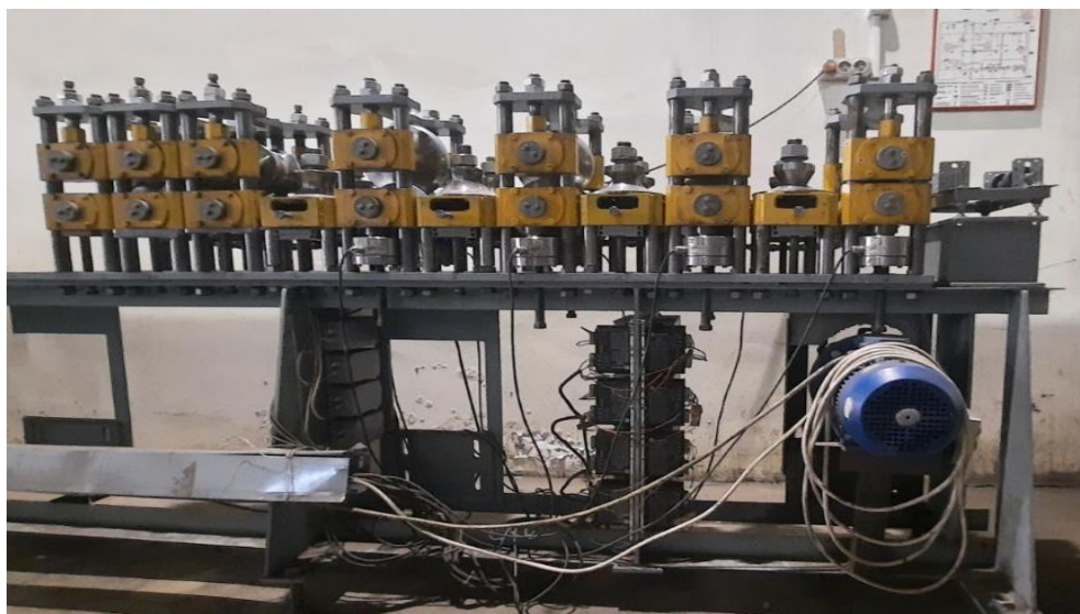
Рисунок 5.2 – Формовочная части экспериментального оборудования ТЭСА 10–60 НИТУ МИСИС
