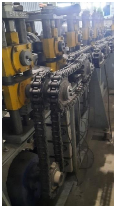
Рисунок 5.3 – Приводная цепи формовочных клеток
