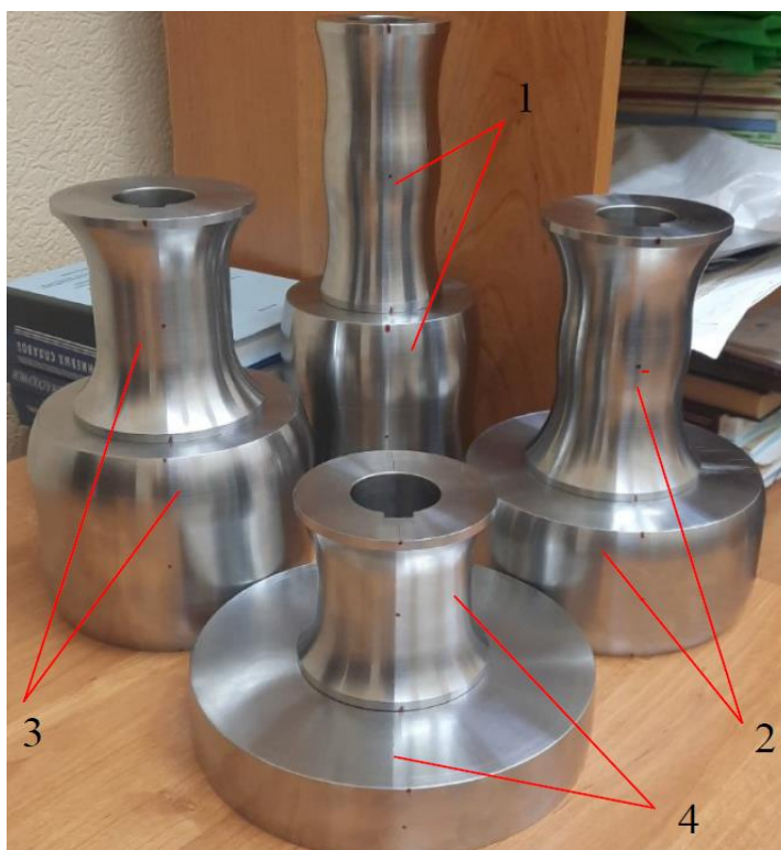
1 - верхний и нижний валки в клетях 1.ОК; 2 - верхний и нижний валки в клетях 2.ОК; 3 - верхний и нижний валки в клетях 3.ОК; 4 - верхний и нижний валки в клетях 4.ОК
