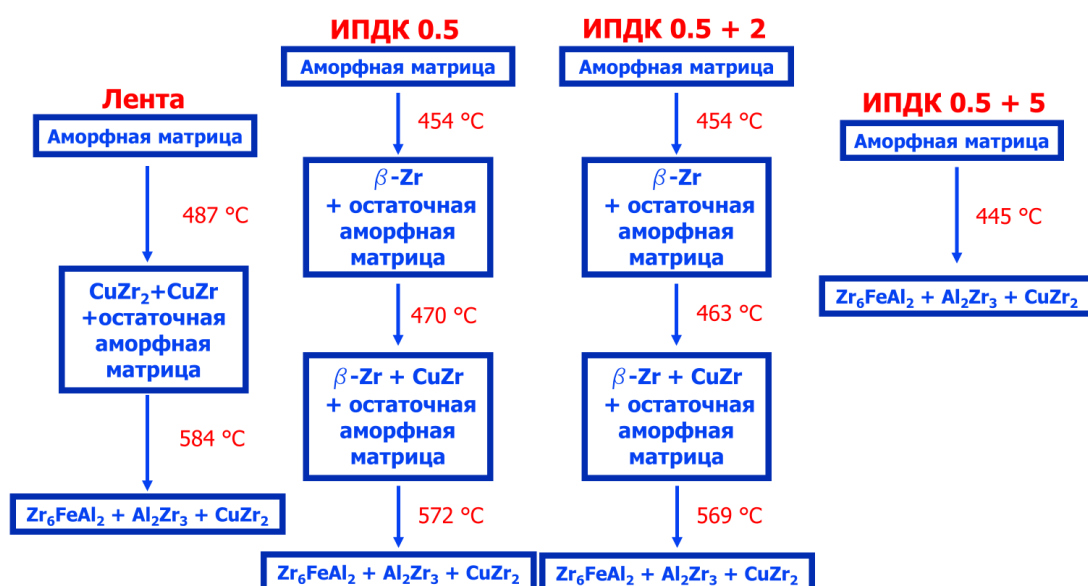
Рисунок 4.3.5. – Схематичное изображение процесса кристаллизации сплава Zr_{62.5}Cu_{22.5}Al_{10}Fe_5 в литом и ИПДК состояниях
