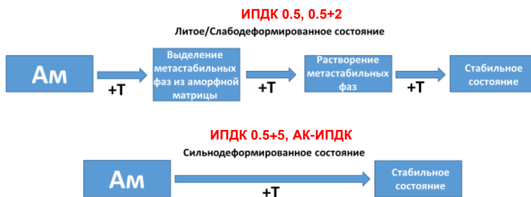
Рисунок 4.4.6 – Схема изменения процессов кристаллизации аморфного сплава Zr_{62.5}Cu_{22.5}Al_{10}Fe_5 под действием деформации
