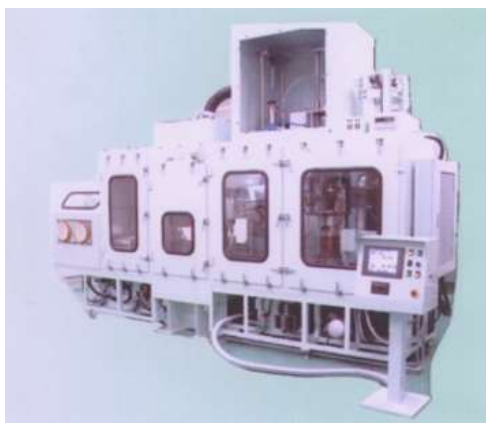
Рисунок 3.4 – Автоматизированный роторный комплекс для сухого квази-изостатического прессования порошков сплавов Nd-Fe-B в резиновой втулке (фото из обзора [3]).
