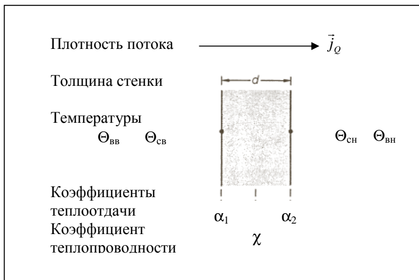
Рис.1. К выводу формулы сопротивления теплопередаче.
